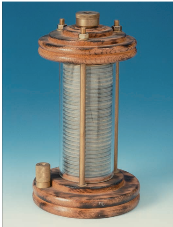
Als Urform des Akkumulators gilt die sogenannte „Rittersche Säule“, die Ritter 1802 entwickelte.
